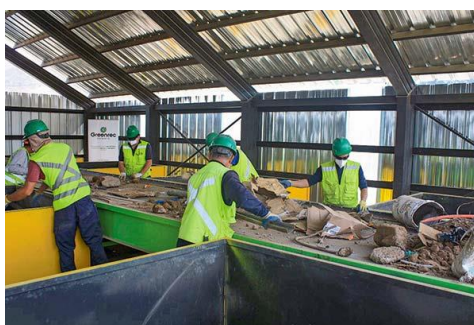
Figura 10. Planta de recuperación de residuos de la construcción y demolición en San Bernardo, Chile (Greenrec, 2023)
